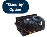
Unità ultra compatte chiamate "invisibili" perché vengono installate sotto il vano motore, lasciando le dimensioni e l'estetica del veicolo invariate e con un evaporatore ultra-sottile.
